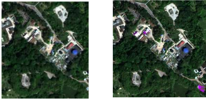
(a). Imagen de la estación de extracción petrolera – (b). Superposición de la capa resultado que delimita la existencia del gas
